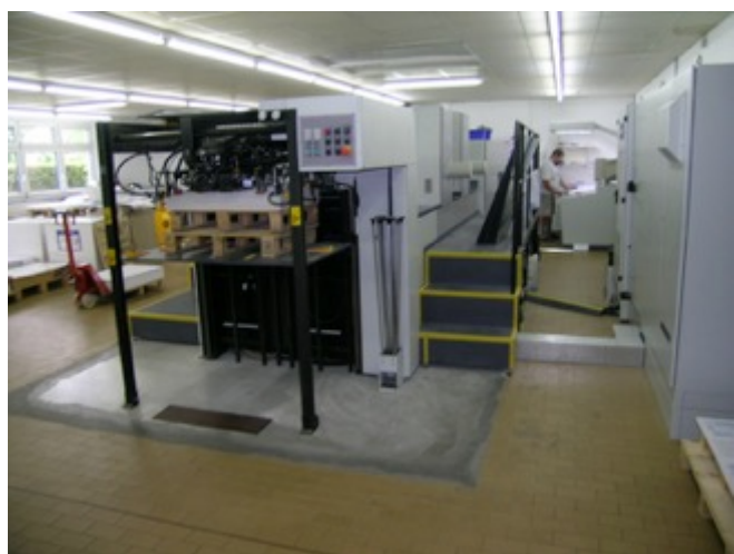
Abbildung 6: Montage MicroMat® und Mörtelinfiltration (links); Belastung einer DUCON Fläche 2 Tage nach Herstellung durch eine Druckmaschine (rechts)
