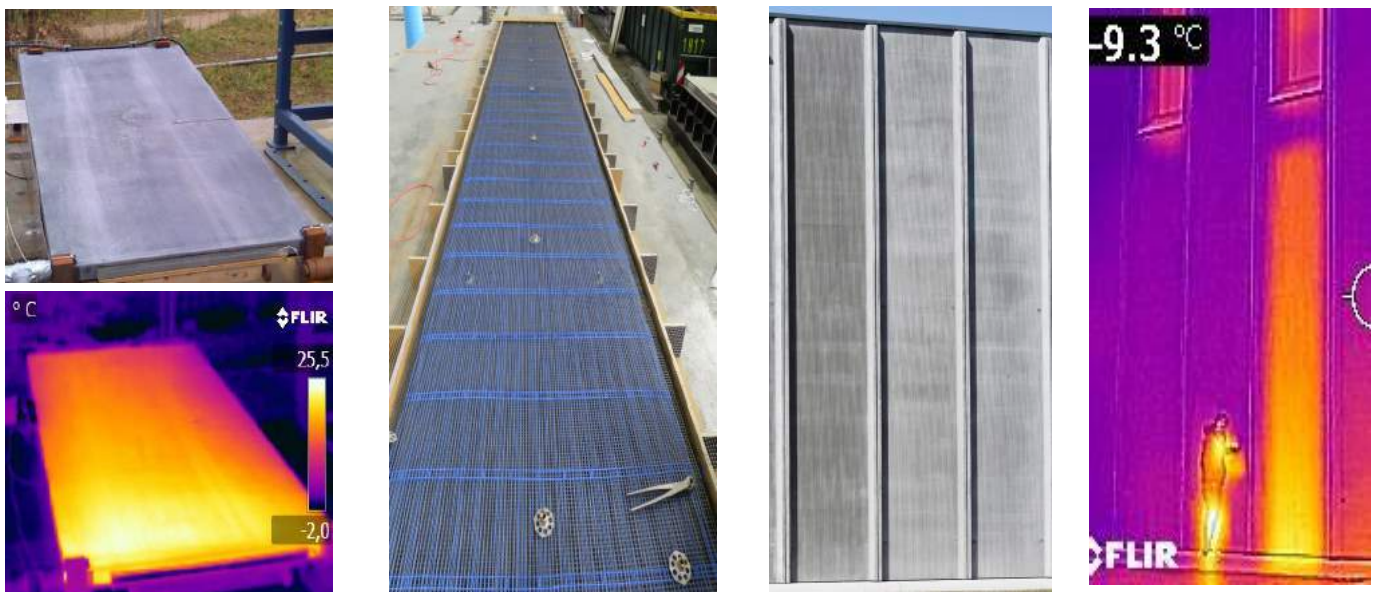
Bild: Herstellung thermisch aktivierter Plattenstreifen zur Warmegewinnung (Glykolgemisch)
