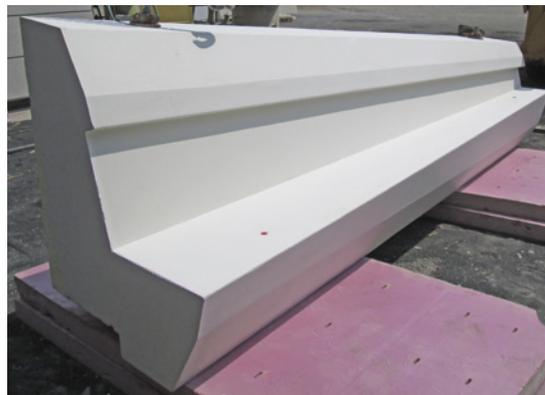
Bild 21: DUCON-Element mit Styroporhinterfüllung
