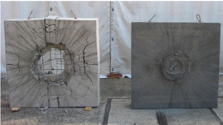
Bild 24: Sprengversuch (Stahlbeton links, DUCON® rechts), Frontseite
