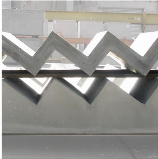
Bild 8: Vergleich DUCON® mit Stahlbetontreppe
