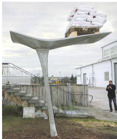
Bild 6: Belastungsversuch mit 850 kg
