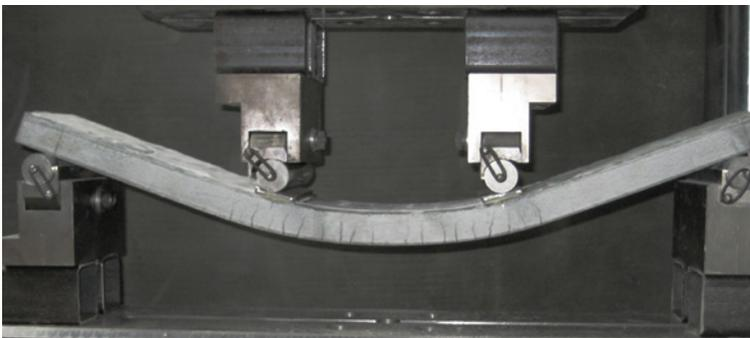
Bild 2: Hohe Duktilität (große Verformungsfähigkeit bei hoher
