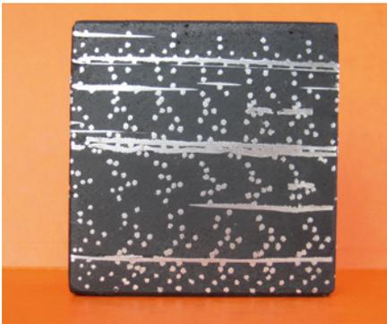
Bild 1: Querschnitt von DUCON®,
