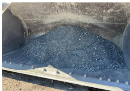
Zuführung des DUCON-Betons, Separierte RC-Gesteinskörnung aus DUCON, Separierte MicroMat-Bewehrung
