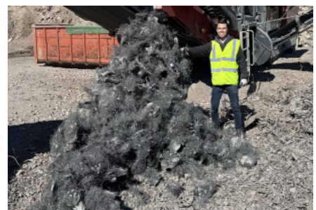
Zuführung des DUCON-Betons, Separierte RC-Gesteinskörnung aus DUCON, Separierte MicroMat-Bewehrung
