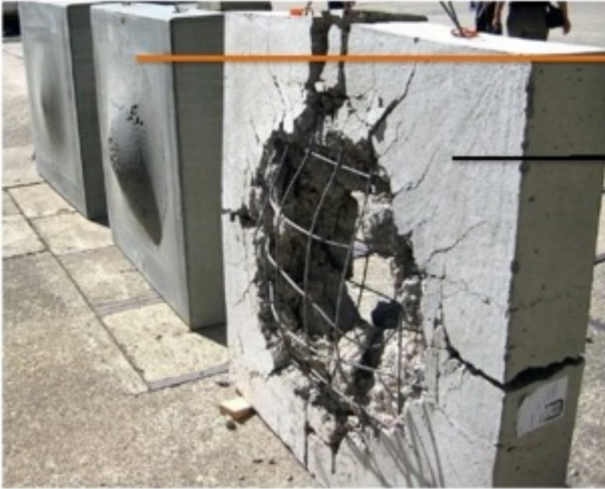
Şekil 3: DUCON ve takviyeli betonunun patlamaya karşı koruması
