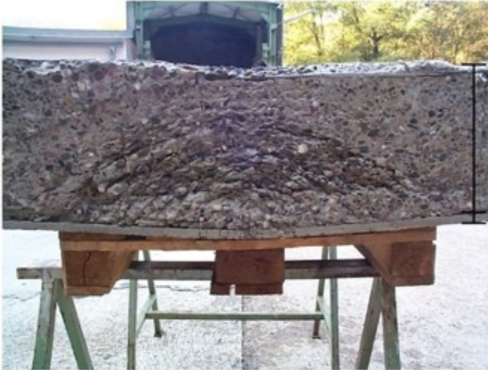
Şekil 9: Döküntü koruma katmanını ile entegre DUCON (Simülasyon testi, ölçek 1:2, Fraunhofer EMI)
