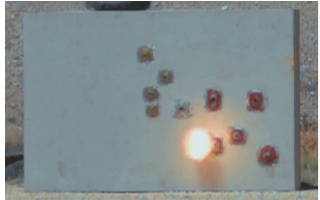
Bild: Beschussversuche mit 12,7mm x 112mm Hartkerngeschoss inkl. Brandsatz (API)
