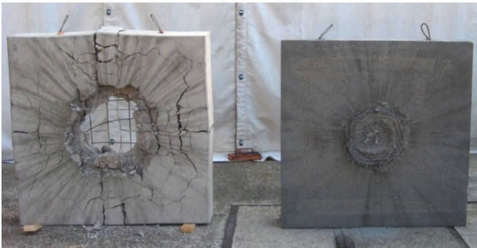
Bild: Stahlbeton mit Durchschuss+Trümmerwurf vs. DUCON mit lokaler Schädigung, keine Durchdringung
